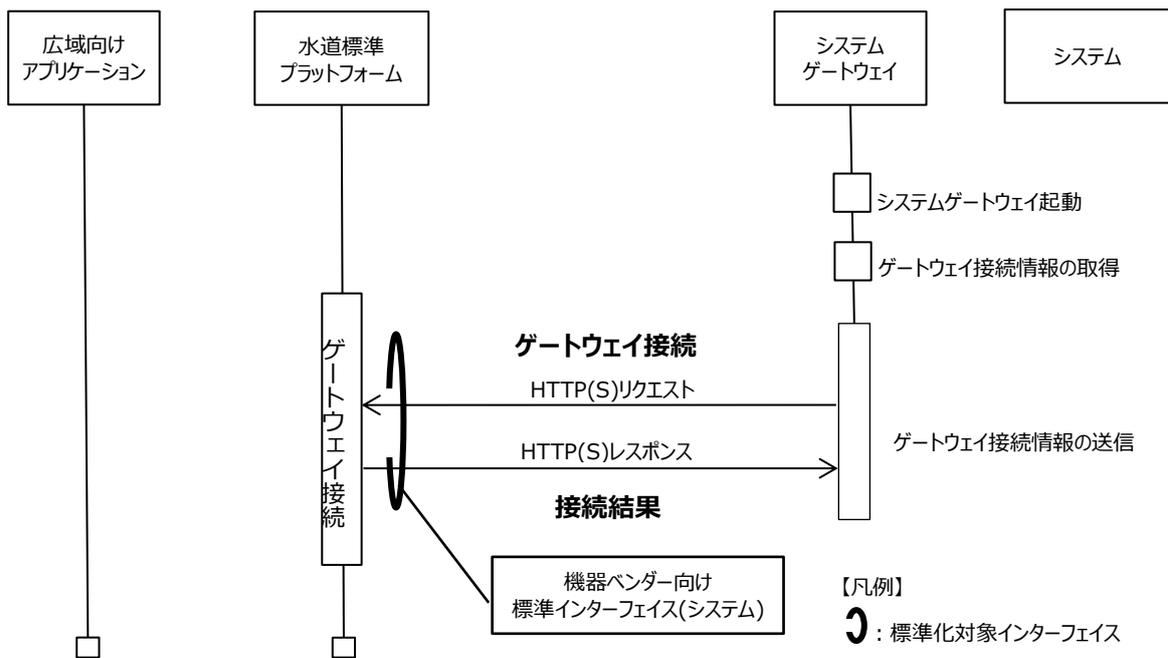
図 3-8: 詳細フロー(ゲートウェイ接続)
