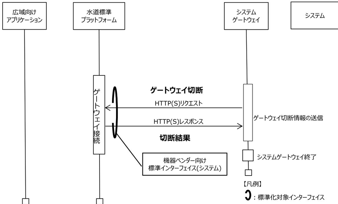
図 3-9: 詳細フロー(ゲートウェイ切断)
