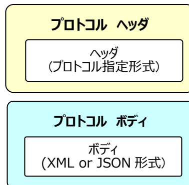
図 3-6 : ヘッダ/ボディのプロトコル設定場所と形式(HTTP(S))
