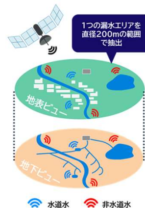
（衛星を活用した水道管路の漏水調査）
